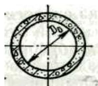
Рис. III.16. Железобетонная фальцевая труба
