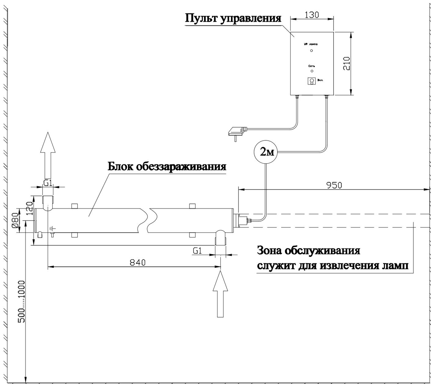
Примечание: монтаж установки к стене производится при помощи двух хомутов  $\varnothing 80$  мм.
