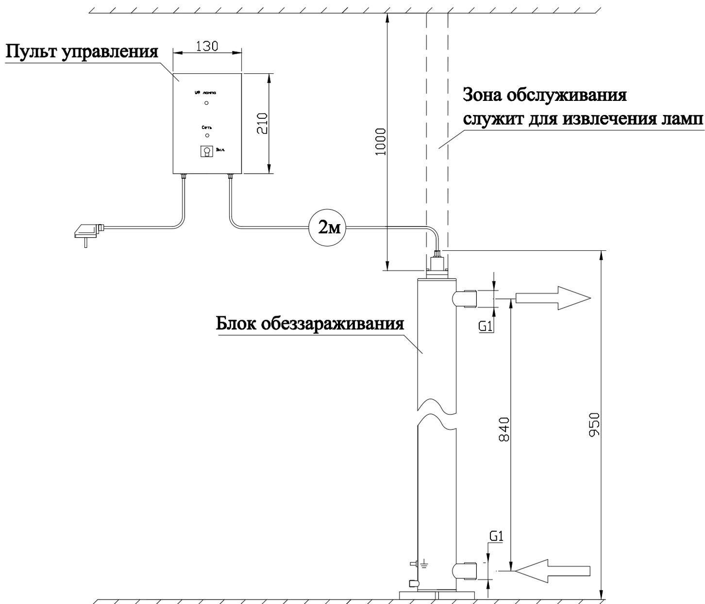
**Примечание: монтаж установки к стене производится при помощи двух хомутов Ø80 мм.**
