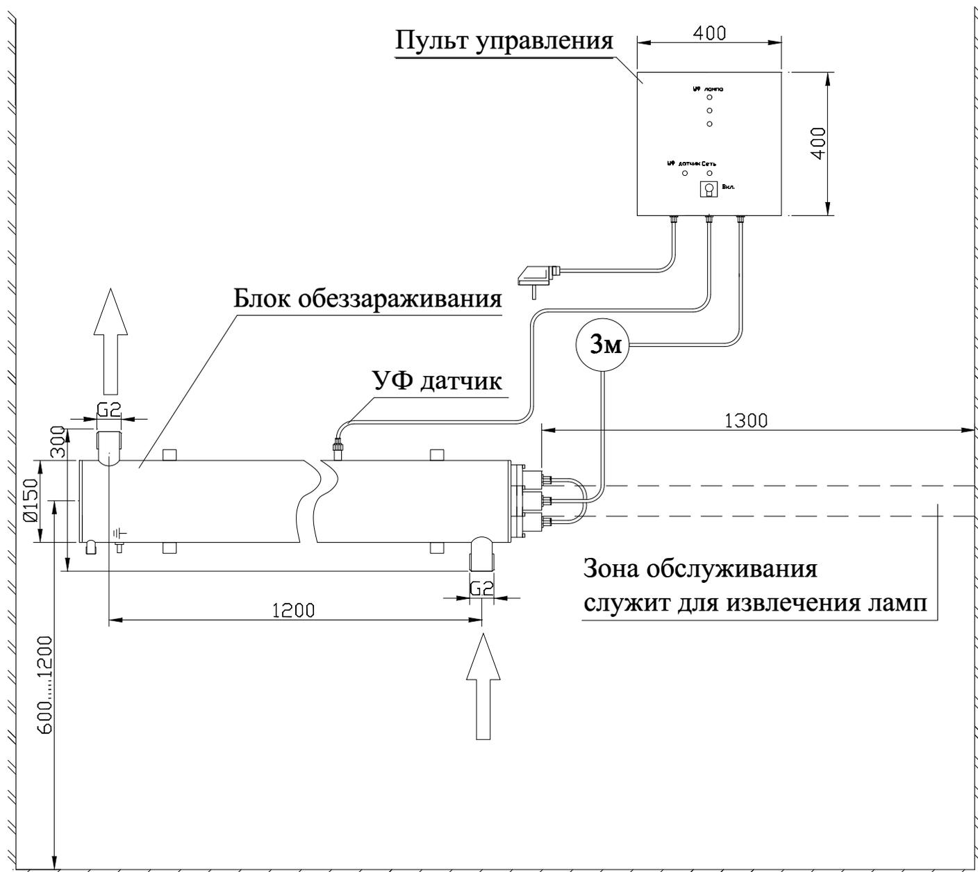
Примечание: монтаж установки к стене производится при помощи двух хомутов Ø150 мм.
