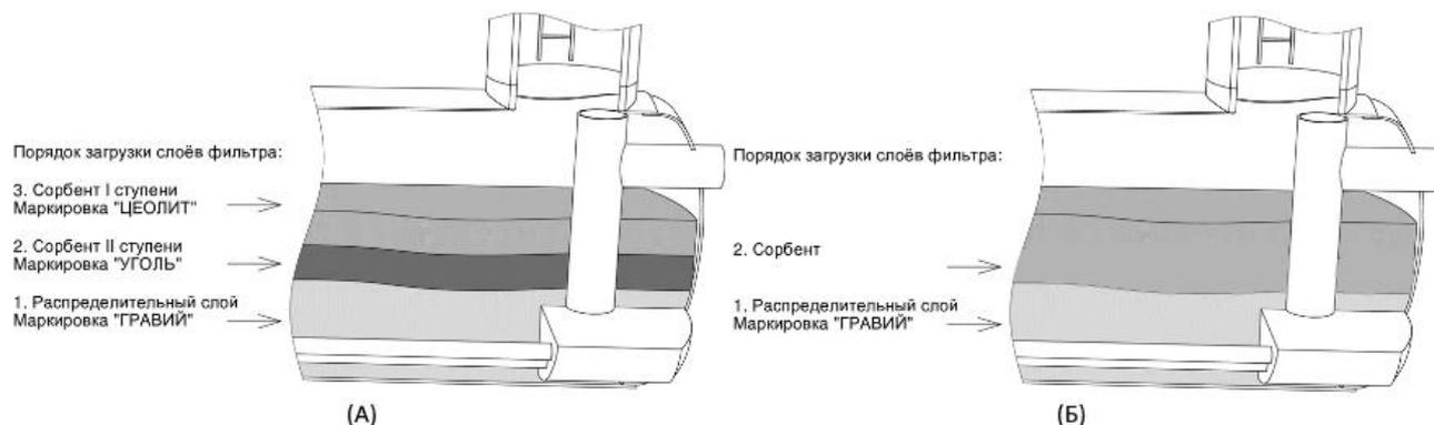
Рисунок 9 – Загрузка фильтра (А) В изделиях с двумя типами сорбента,
